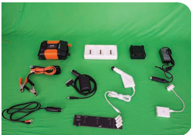
Acessórios (Hub, carregador veicular e inversor de voltagem)
